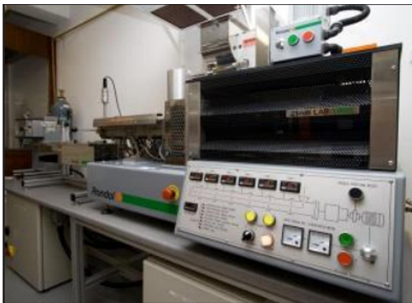
Slika 3.1. Dvopužni ekstruder RONDOL BenchTop 21 mm, UK
