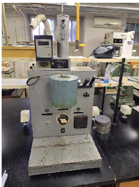
Slika 3.3. Uređaj za mjerenje brzine protjecanja taljevine Ceast MFI, Instron, USA
