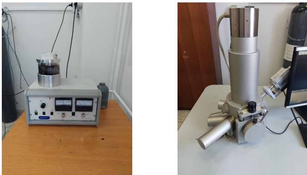
*Slika 30.* Uredaj za naparivanje uzoraka (lijevo) i SEM mikroskop (desno)
