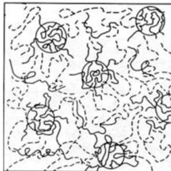
Slika 4. Morfologija djelomično mješljivih mješavina polimera A (puna linija) i polimera B (iscrtkana linija) 6
