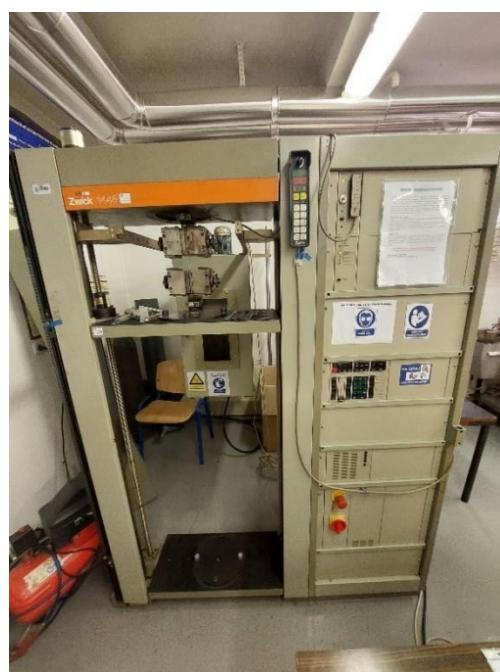
*Slika 32.* Univerzalna mehanička kidalica Zwick 1445
