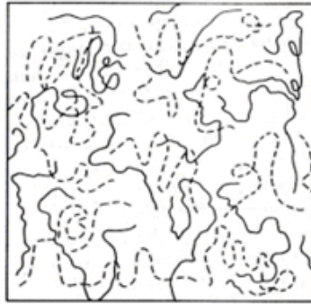
Slika 3. Morfologija mješljivih mješavina polimera A (puna linija) i polimera B (iscrtkana linija) 6
