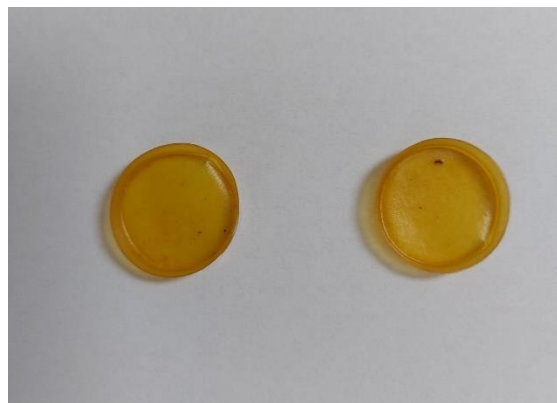
Slika 71. Hidrogelovi s nepročišćenom peludi
