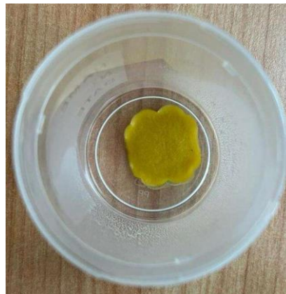
Slika 59. Hidrogel s pročišćenom peludi
