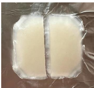
Slika 72. Prereznani uzorak hidrogela bez peludi
