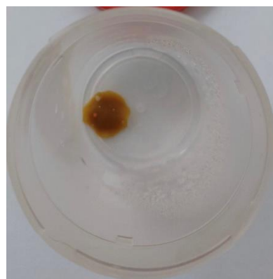
Slika 69. Hidrogel s nepročišćenom peludi
