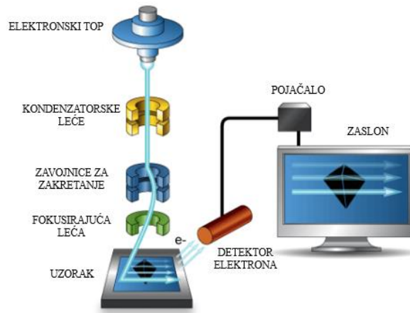
Slika 18. Shematski prikaz SEM mikroskopa [44]
