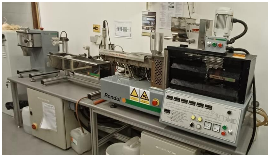
Slika 22. Dvopužni laboratorijski ekstruder, Randol Bench Top 21
