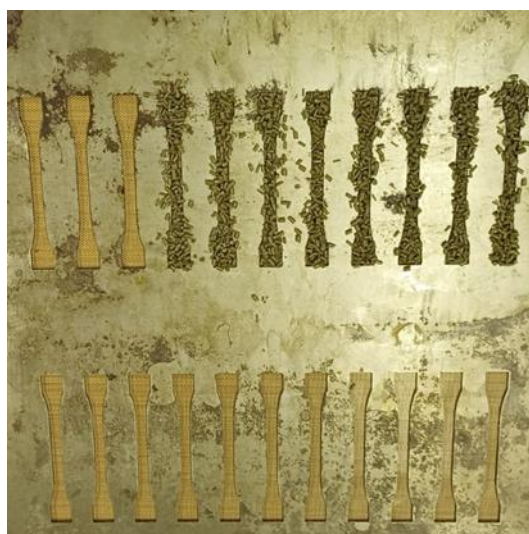
Slika 26. Uzorci PP stavljeni u kalup za prešanje
