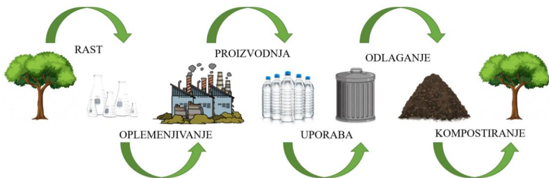
Slika 6. Tijek životnoga ciklusa biorazgradljivog polimernog materijala [16]
