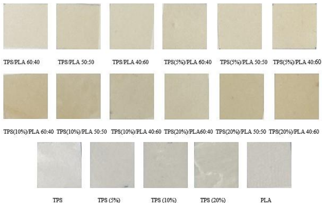
Slika 18. Filmovi pripremljenih uzoraka polimernih mješavina za provedbu procesa biorazgradnje
