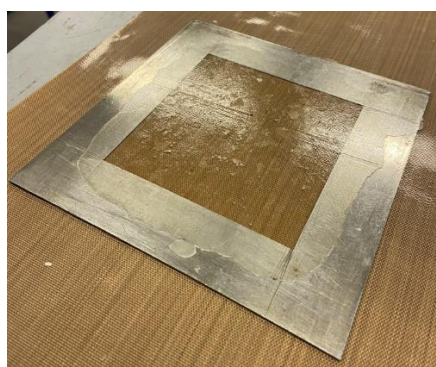
Slika 17. Uzorak u kalupu za prešanje
