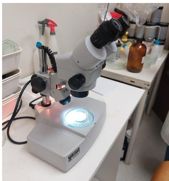
Slika 25. Stereo lupa za određivanje pokretljivosti Daphnia magna i provjere unosa MP-a u jedinke.
