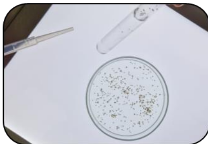
Uzimanje Daphnia magna pomoću Pastuer pipete i prenošenje u jažicu
