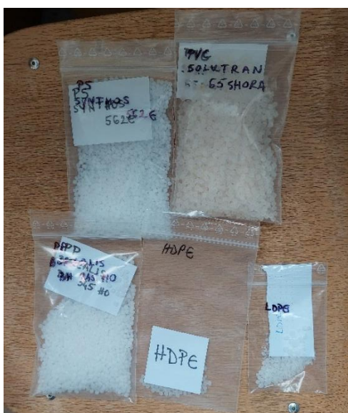
Slika 11. Uzorci pet različitih vrsta MP-a koji su primijenjeni u obliku kuglica u svrhu odabira optimalne metode razgradnje
