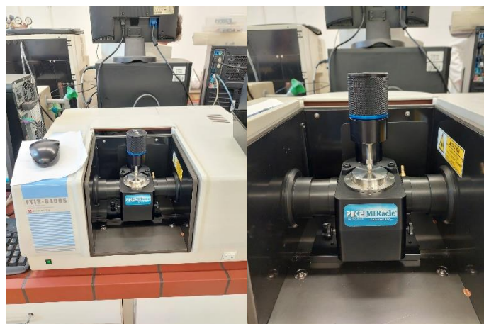
Slika 18. FTIR-ATR uređaj za analizu filtrirane MP
