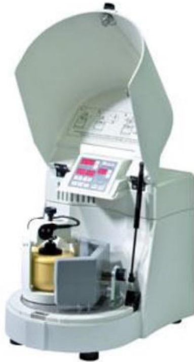
Slika 11. Planetarni mlin FritschPulverisette 6 ( Fritsch, Njemačka )
