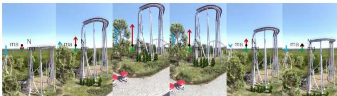
Slika 5 Slike padajućeg tornja s ucrtanim silama koje na njega djeluju. [12]
