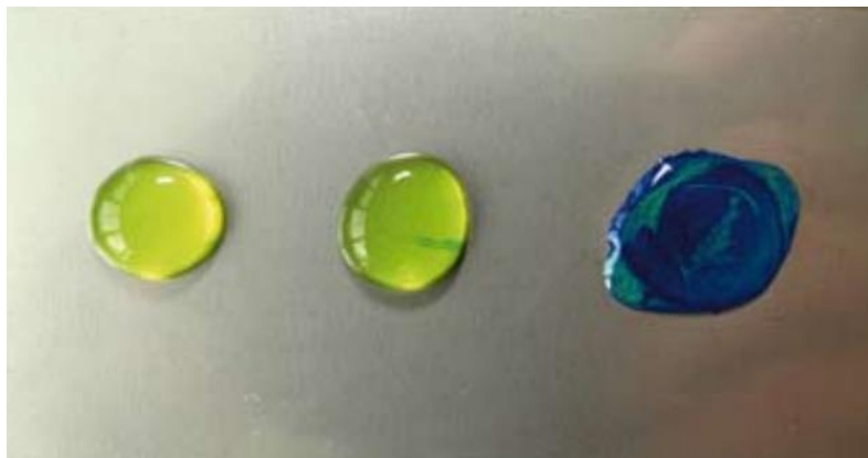
Slika 2. Rezultati feroksil testa [5]
