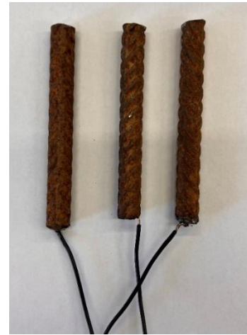
Slika 8. Priprema uzorka: senzorsko kućište (lijevo), armatura (desno)
