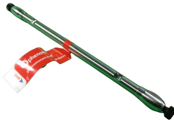
*Slika 23.* Korištena Kinetex kolona
