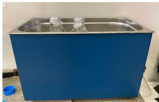
**Slika 25.** Ultrazvučna kupelj UZ 20R, Iskra
