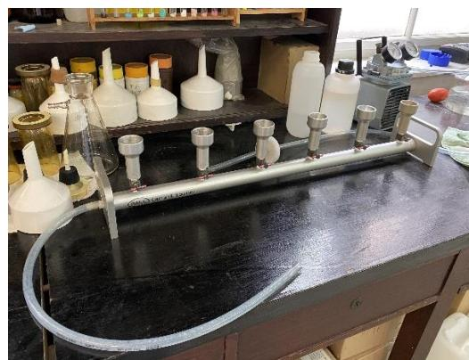
**Slika 26.** Uređaj za filtraciju PALL Life Sciences
