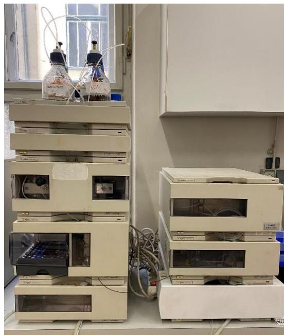
**Slika 27.** Uredaj Agilent 1100 Series s DAD detektorom, Agilent Technologies
