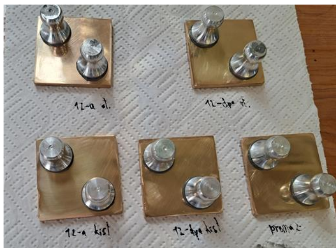
Slika 14. Pločice s pričvršćenim čunjićima za pull-off test
