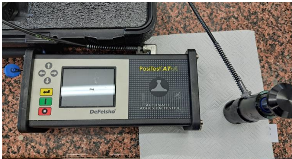
Slika 15. PosiTest AT-A, uređaj za izvođenje pull-off testa
