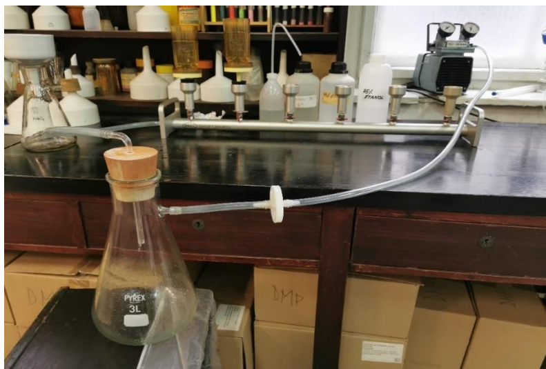
Slika 19. Vakuum filtracija za pročišćavanje realnog uzorka otpadne vode
