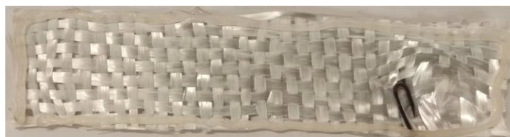
Slika 11. Staklena mrežica s imobiliziranim TiO_2
