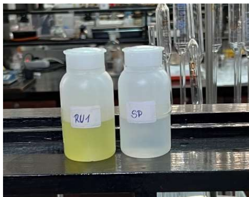
Slika 24. Pripremljene otopine za ICP-OES analizu
