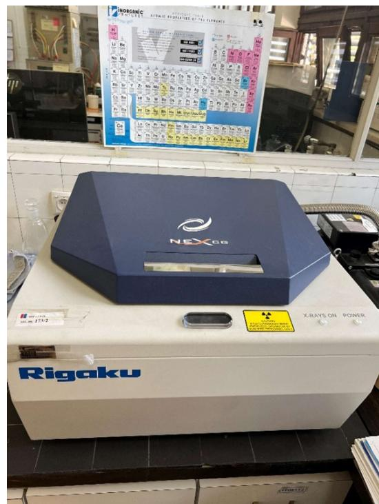
**Slika 14.** EDXRF spektrometar NEX CG
