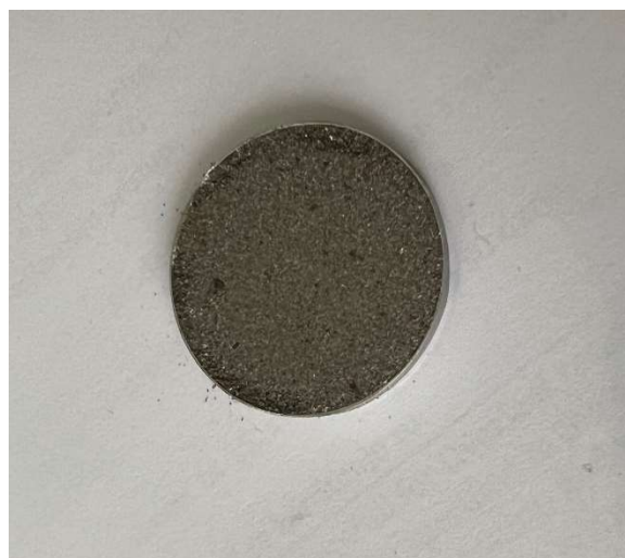
Slika 26. Pripremljeni uzorak za EDXRF analizu
