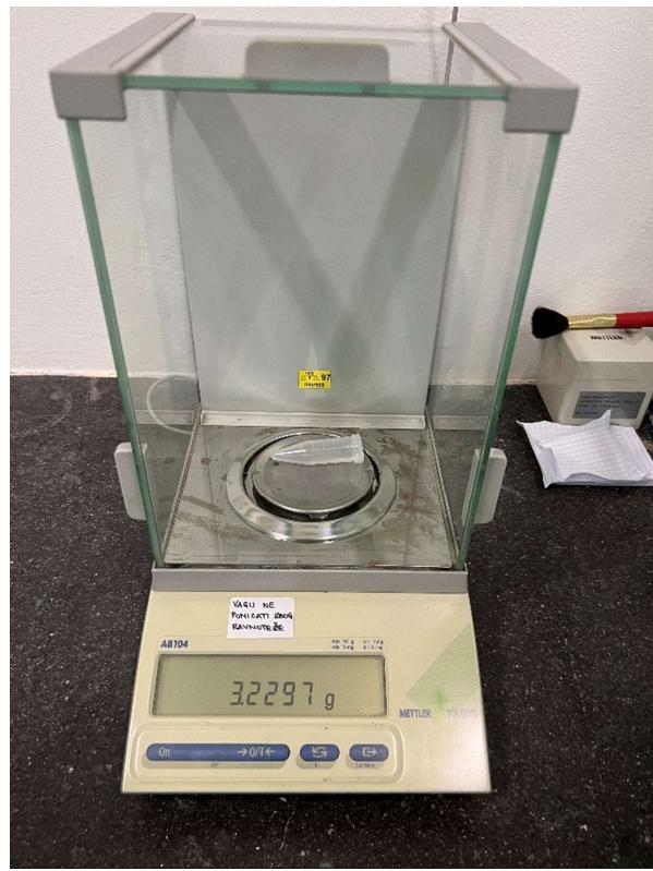
Slika 17. Analitička vaga AB104 Mettler Toledo
