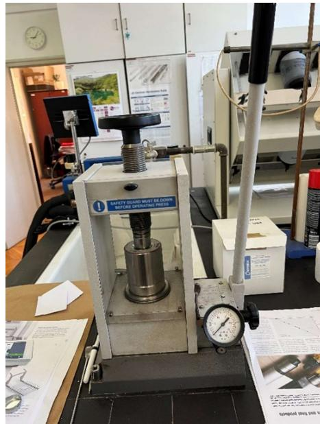
**Slika 25.** Hidraulička preša
