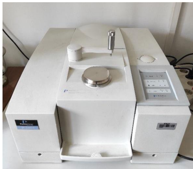
Slika 14. FTIR spektrometar, Perkin Elmer Spectrum One Spectrometer
