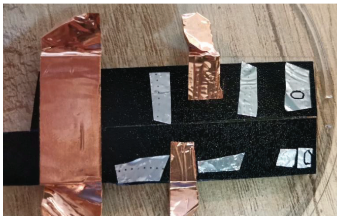
Slika 22. SEM analiza provedena uz vodljivu podlogu načinjena od ugljikove i bakrene trake
