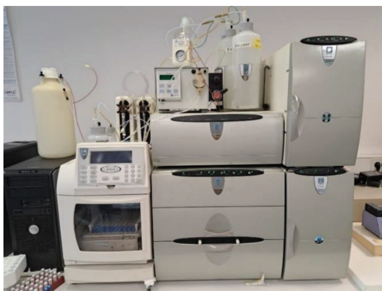
Slika 23. Ionski kromatograf Dionex ICS 3000
