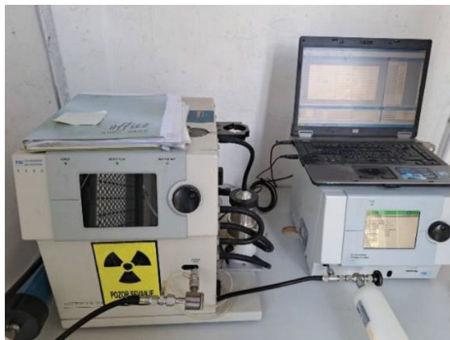
Slika 15. Spektrometar za brojanje submikronskih čestica SMPS 3936L75
