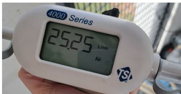
Slika 26. Instrument za mjerenje protoka (Flowmeter TSI-4000)
