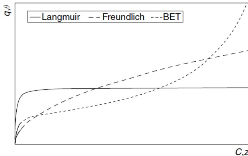
**Slika 10.** Graf ovisnosti količine adsorbata izraženih kao maseni udio  $q$  ili udio mjesta zauzetih za BET izotermu,  $\theta$ , ovisno o njegovoj koncentraciji  $C$  ili tlaku plinovitog adsorbata u odnosu na tlak zasićenja,  $z$ . Langmuirova izoterma (puna linija), Freundlichova izoterma (isprekidane crte), BET izoterma (točke) [10]
