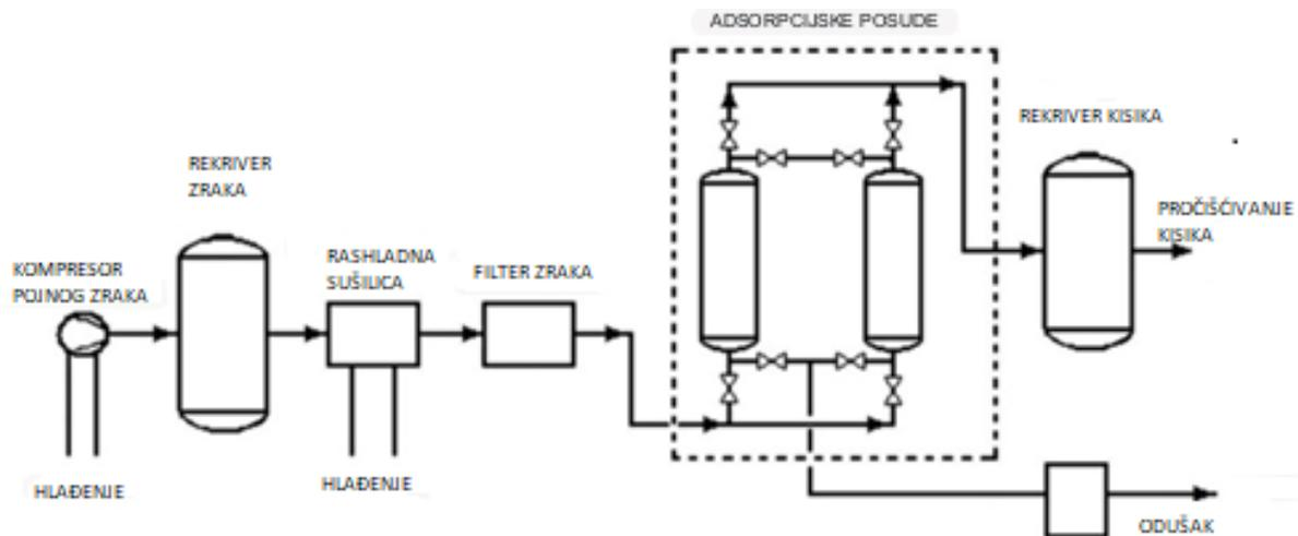
**Slika 14.** Sustav adsorpcije uz primjenu vakuuma [12]
