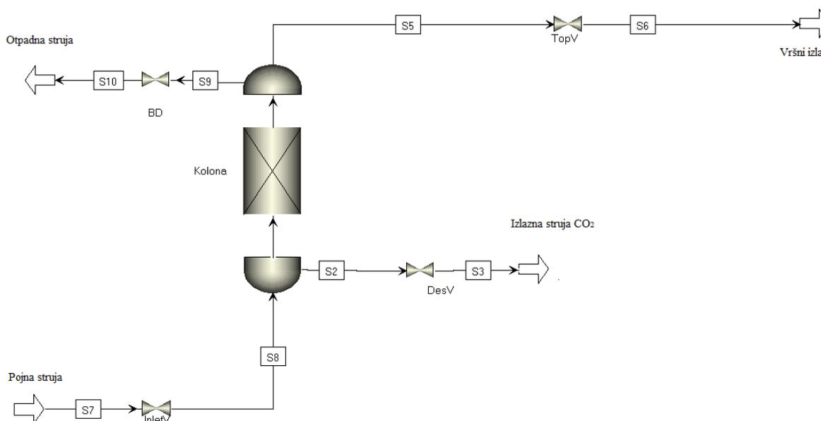
**Slika 20.** Simulacija drugog stupnja u Aspen Adsorptionu
