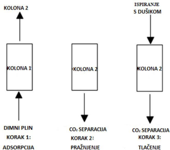
**Slika 15.** Radni koraci za adsorpciju uz primjenu vakuuma [12]
