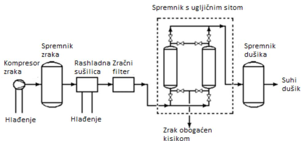
**Slika 11.** Shematski dijagram adsorpcijskog sustava s promjenom tlaka [12]
