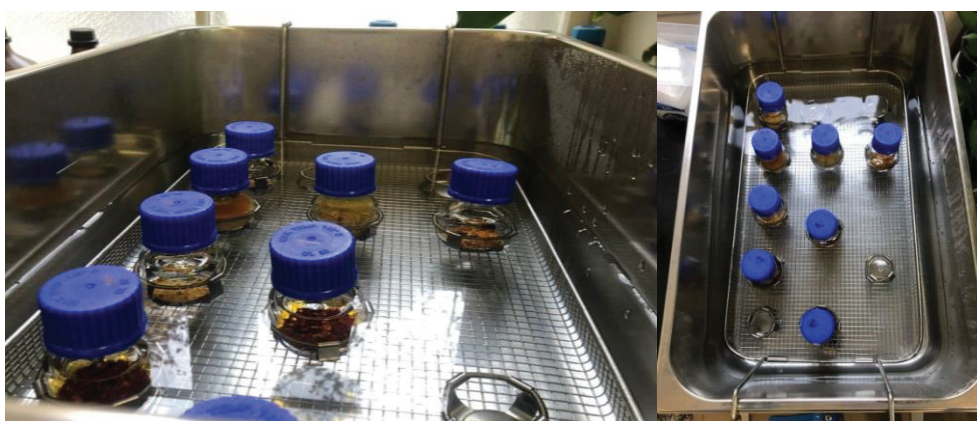
Slika 21 i 22. Ekstrakcija potpomognuta ultrazvukom
