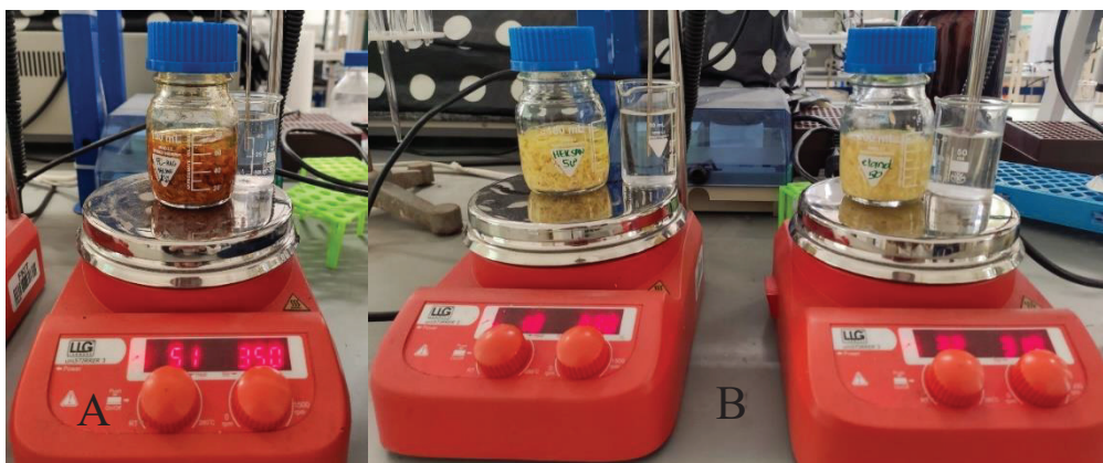
Slika 20. A) Ekstrakcija svježe kurkume u n -heksanu pri 50 °C i B) ekstrakcija svježeg đumbira u n -heksanu pri 50 °C u n -heksanu (lijevo) i u etanolu pri 50 °C (desno)
