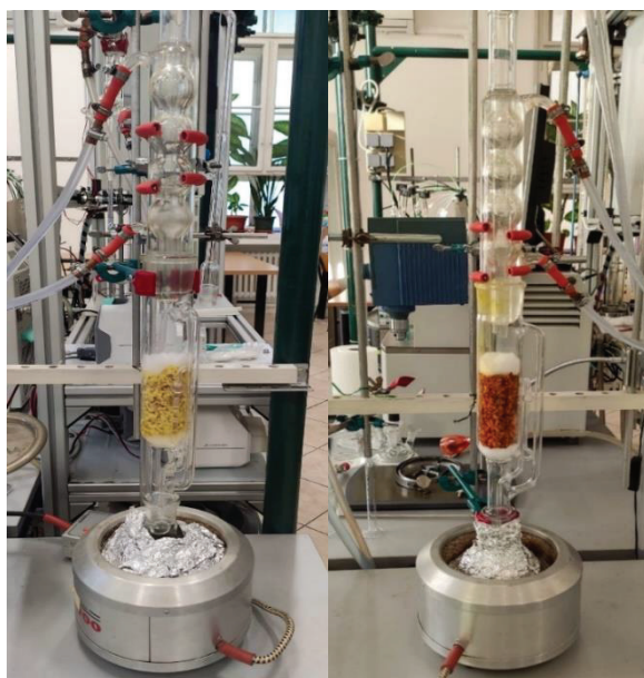
Slika 18. Ekstrakcija đumbira (lijevo) i kurkume (desno) pomoću Soxhlet uređaja
