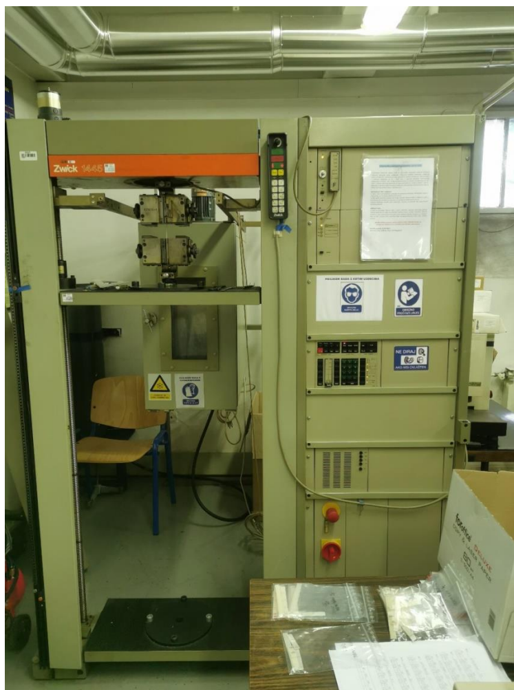
Slika 17. Mehanička kidalica Zwick 1445
