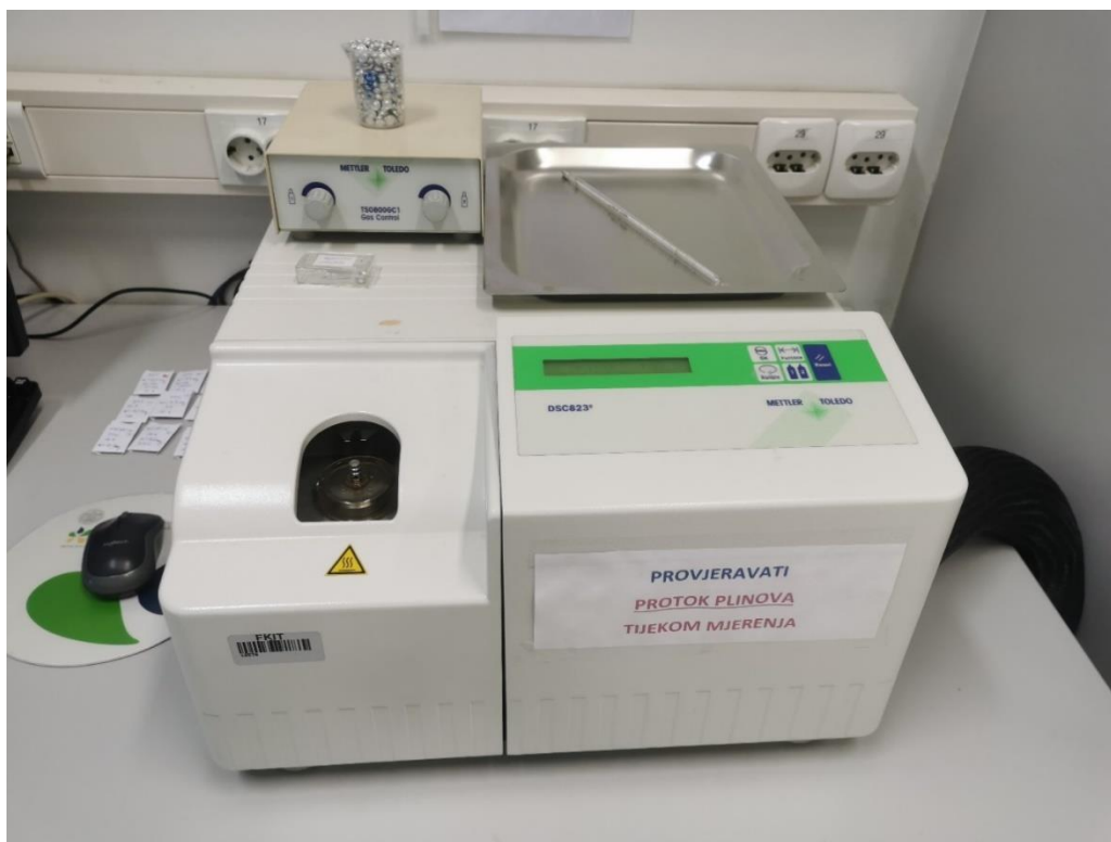
Slika 18. Diferencijalni pretražni kalorimetar, DSC - Mettler Toledo
