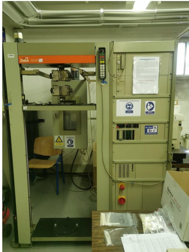
Slika 17. Mehanička kidalica Zwick 1445
