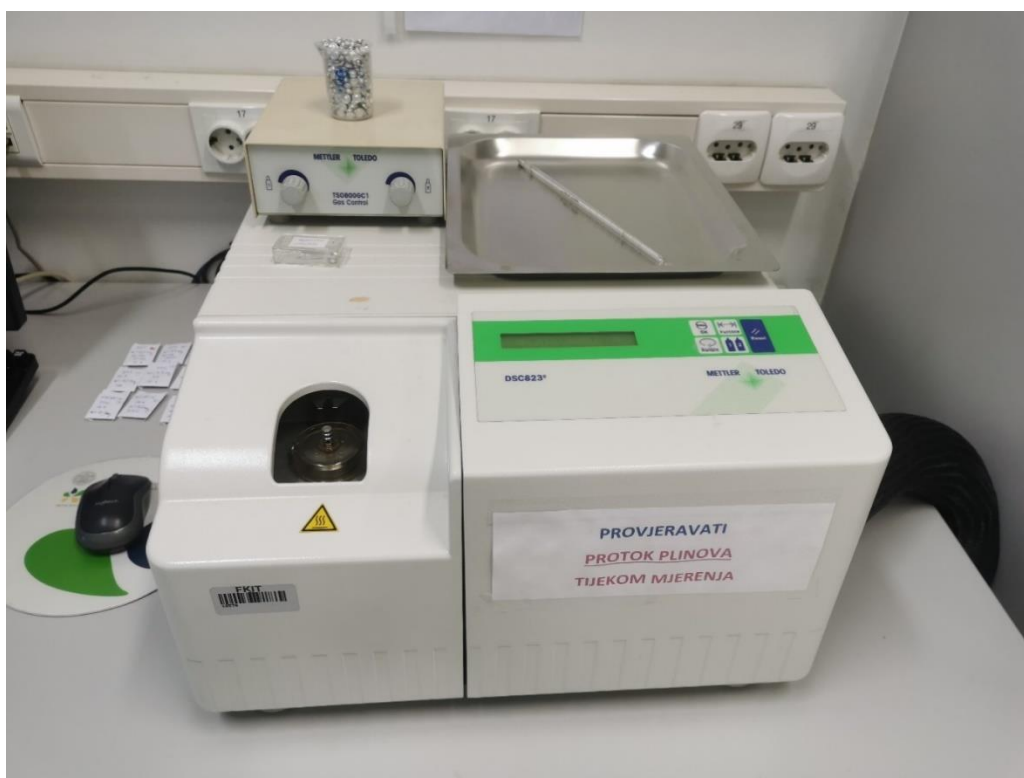
Slika 18. Diferencijalni pretražni kalorimetar, DSC - Mettler Toledo
