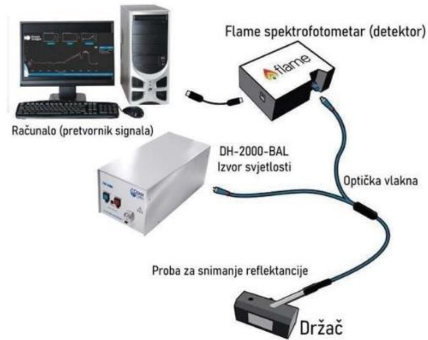
Slika 18. Prikaz uređaja Ocean Optics Flame korištenog za mjerenje reflektancije.
