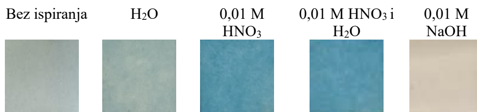
Slika 21. Papirne trake berlinskog modrila: bez ispiranja, ispranih samo vodom, samo kiselinom, vodom i kiselinom zajedno te lužinom.
