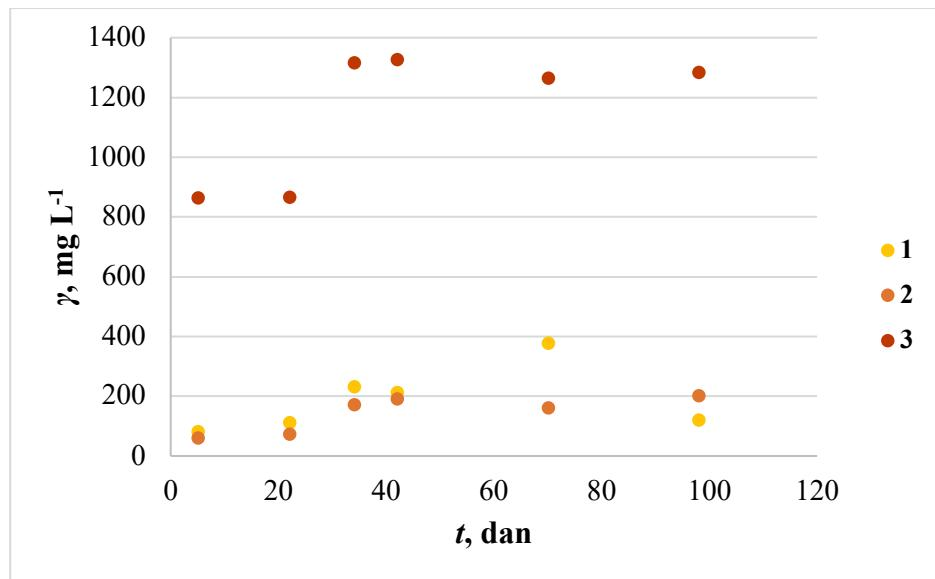
**Slika 33.** Promjena koncentracije kapsaicina dobivenog ultrazvučnom ekstrakcijom (pri 25 °C) s vremenom.
