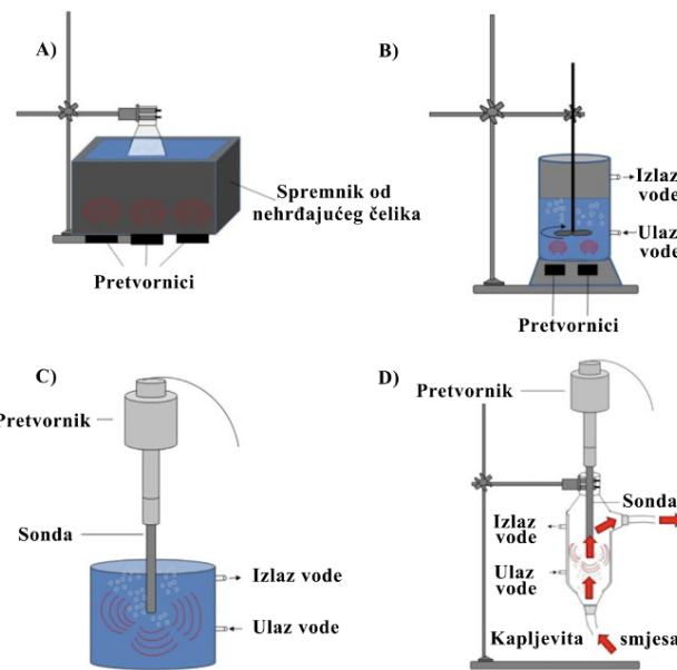
**Slika 10.** Različiti ultrazvučni sustavi: A) Ultrazvučna kupka, B) Ultrazvučni reaktor s miješalom, C) Ultrazvučna sonda, D) Kontinuirana sonikacija ultrazvučnom sondom [20].
