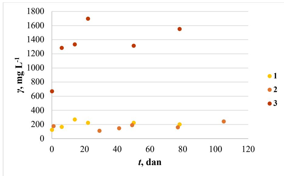
**Slika 29.** Promjena koncentracije kapsaicina dobivenog ekstrakcijom uz magnetsko miješanje (procesni uvjeti:  $T = 25 \text{ }^{\circ}\text{C}$ ,  $t = 3 \text{ h}$ ) s vremenom.
