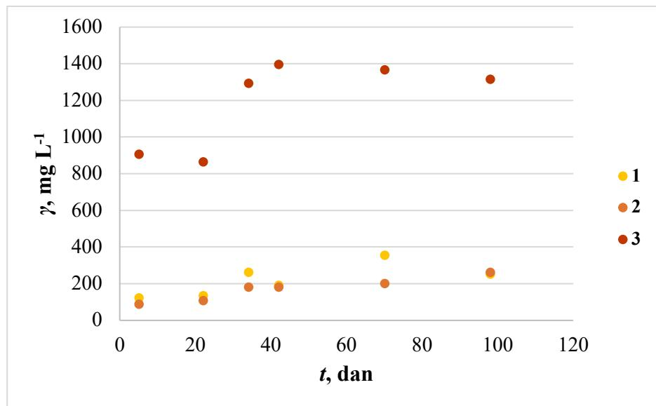
**Slika 34.** Promjena koncentracije kapsaicina dobivenog ultrazvučnom ekstrakcijom (pri 50 °C) s vremenom.
