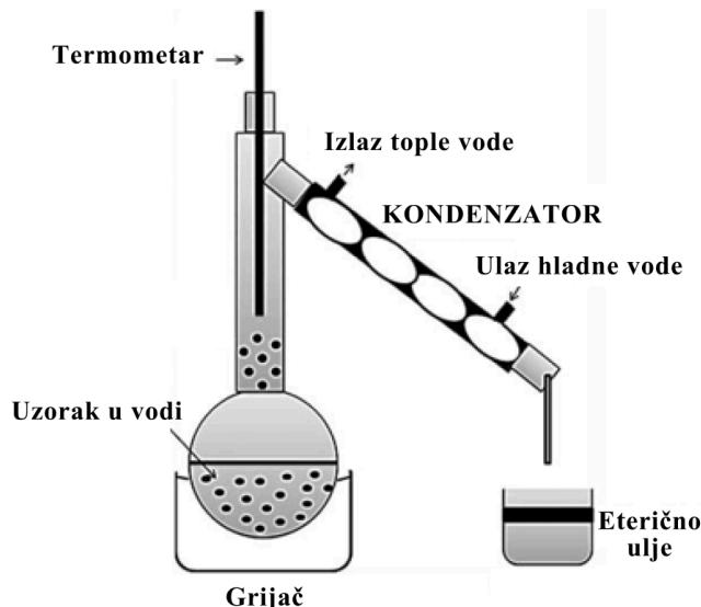
**Slika 9.** Aparatura za ekstrakciju hidrodestilacijom [18].
