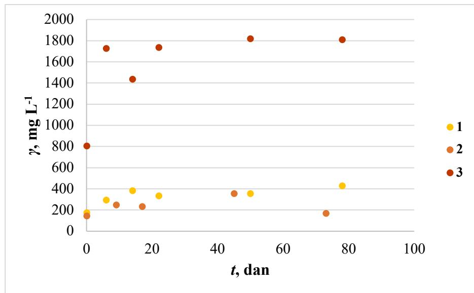
**Slika 30.** Promjena koncentracije kapsaicina dobivenog ekstrakcijom uz magnetsko miješanje (procesni uvjeti:  $T = 50 \text{ }^{\circ}\text{C}$ ,  $t = 3 \text{ h}$ ) s vremenom.
