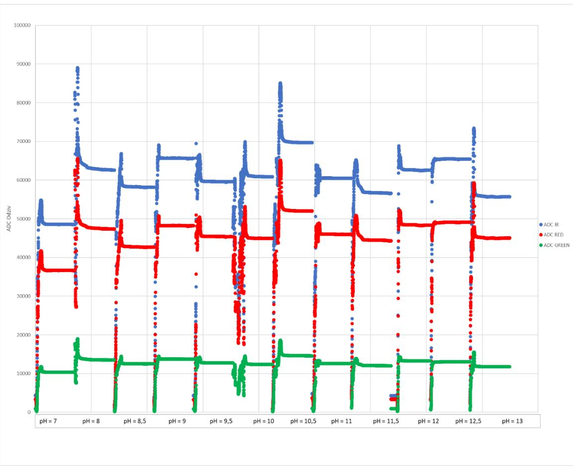
Slika 27. Sirovi ADC podaci u ovisnosti o pH za papirić kurkumina  $c = 1 \times 10^{-5}$  M
