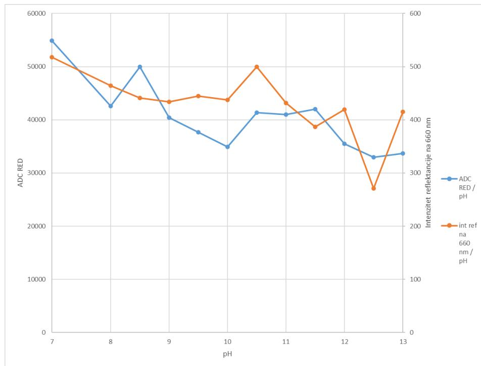
Slika 43. Podudaranje ADC RED odziva i intenziteta reflektancije na 660 nm [na  $\lambda$  na kojoj crvena LED dioda radi] pri koncentraciji kurkumina od  $c = 1 \times 10^{-4}$  M
