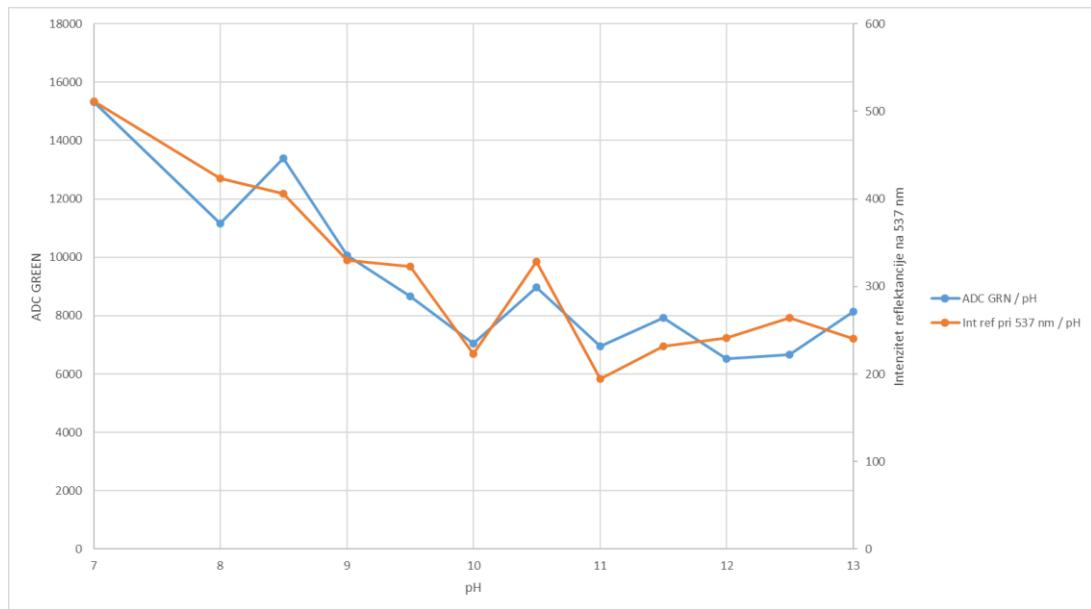
Slika 40. Podudaranje ADC GREEN odziva i intenziteta reflektancije na 537 nm [na  $\lambda$  na kojoj zelena LED dioda radi] pri koncentraciji kurkumina od  $c = 1 \times 10^{-4} \text{ M}$
