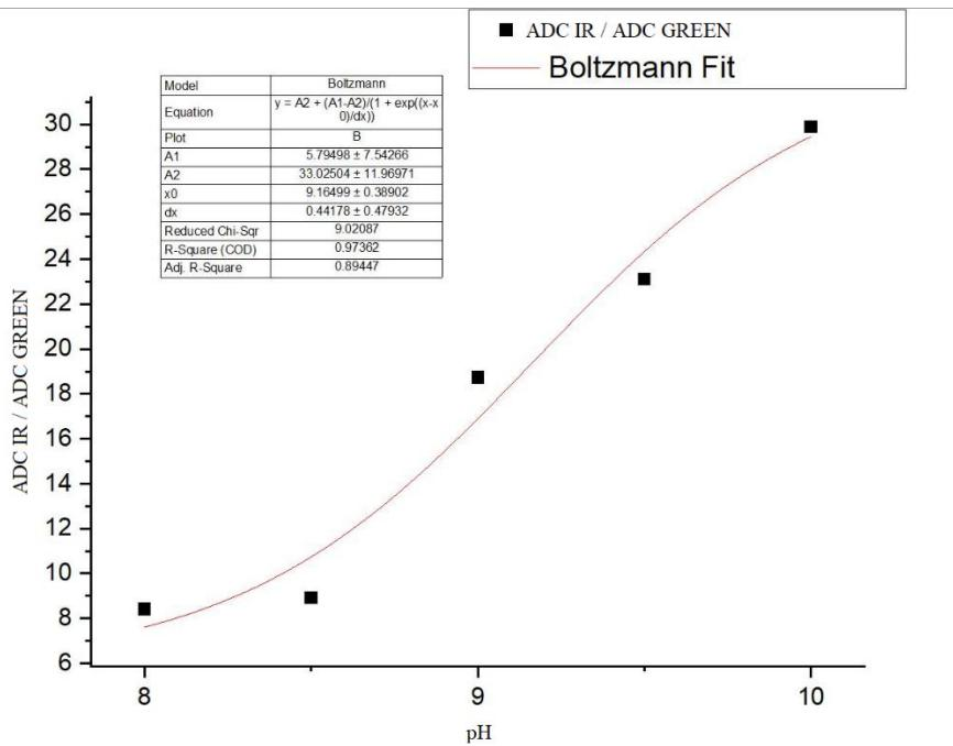
Slika 53. Sigmoidalna pH titracijska krivulja kao ovisnost omjera intenziteta ADC odziva PPG sustava - infracrvene LED diode (870 nm) i zelene LED (537 nm) diode o pH u rasponu od pH = 8 do pH = 10
