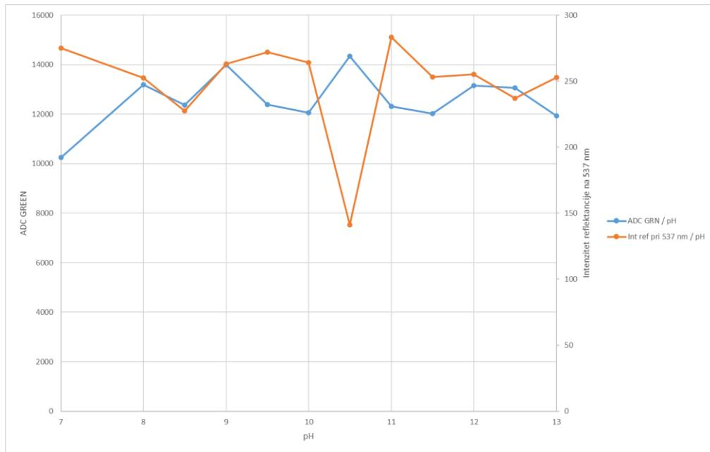
Slika 39. Podudaranje ADC GREEN odziva i intenziteta reflektancije na 537 nm [na  $\lambda$  na kojoj zelena LED dioda radi] pri koncentraciji kurkumina  $c = 1 \times 10^{-5} \text{ M}$
