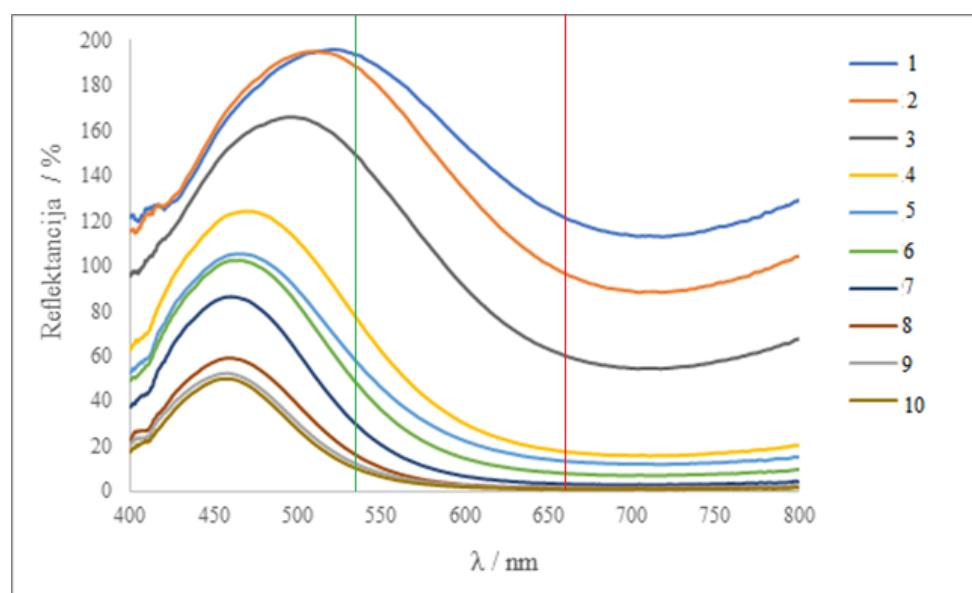
Slika 21. Reflektancijski spektri korištenih papira s berlinskim modrilom s naznačenim valnim duljinama MAX30101 crvene (660 nm) i zelene (537 nm) LED diode
