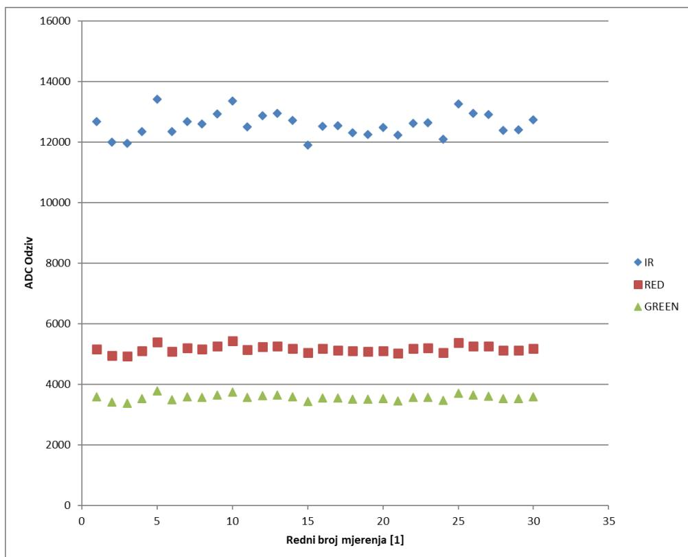
Slika 26. ADC Odzvi svih LED dioda za papirić označen brojem 10
