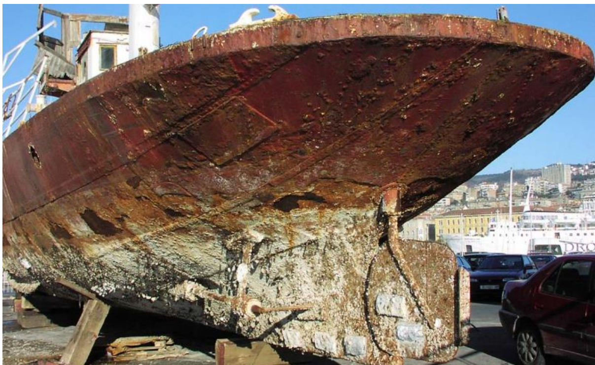
Slika 2. Šteta uzrokovana korozijom 5
