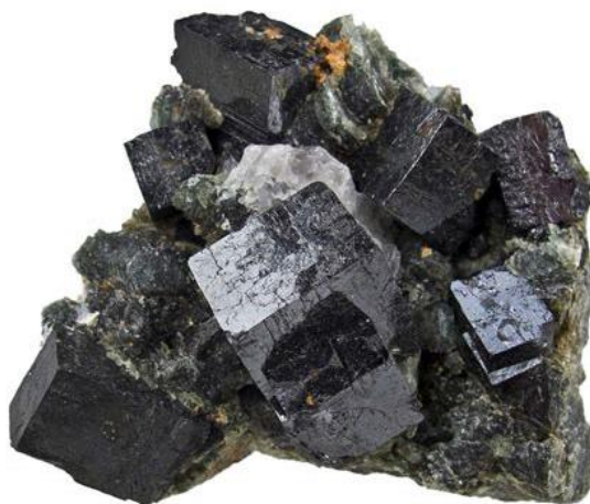
Slika 1. Prvi otkriveni perovskit, kalcijev titanat ( \text{CaTiO}_3 ) 5
