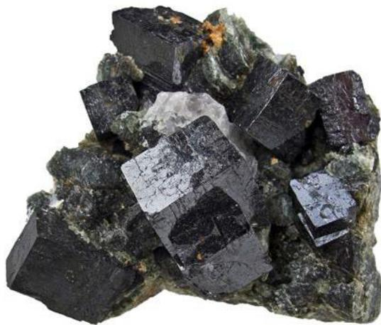
Slika 1. Prvi otkriveni perovskit, kalcijev titanat ( $\text{CaTiO}_3$ )<sup>5</sup>
