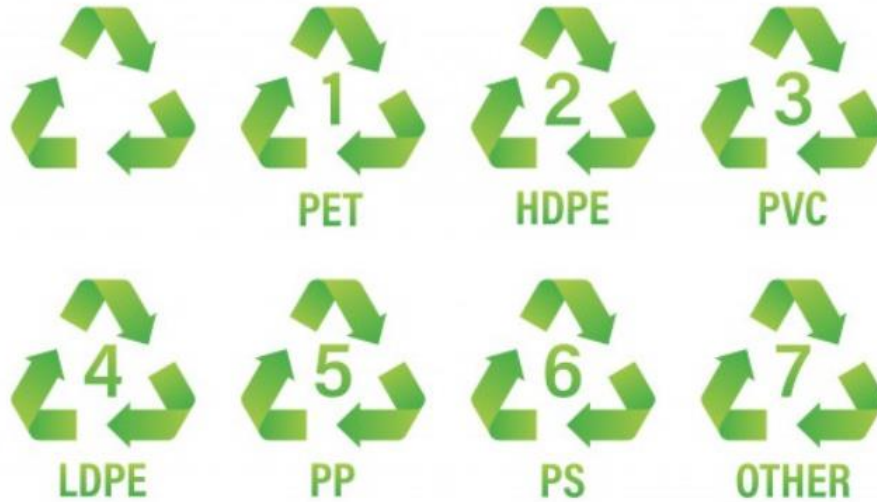
Slika 2. Oznake (brojčane i kratice) ambalažne plastike [8].
