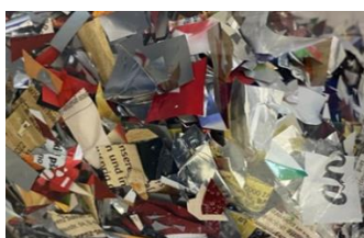
Slika 21. Usitnjeni ambalažni dvostruko-orijentirani PP.
