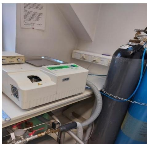
**Slika 23.** DSC uređaj MettlerToledo DSC 822e
