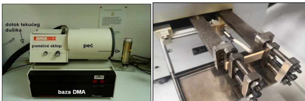
Slika 25. DMA analizator , DMA 983 TA Instruments,USA
