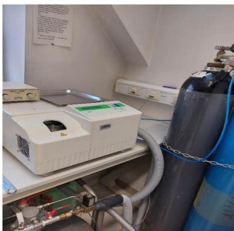
Slika 23. DSC uređaj MettlerToledo DSC 822e
