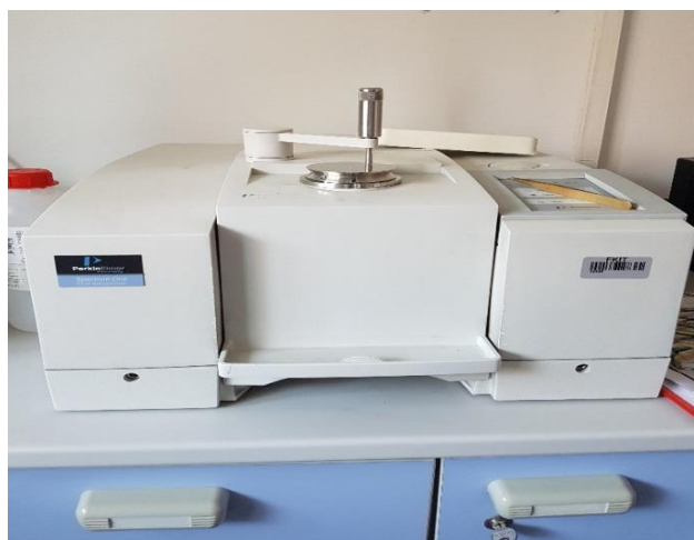
Slika 26. Spektrofotometar FT-IR Spectrum One, Perkin Elmer
