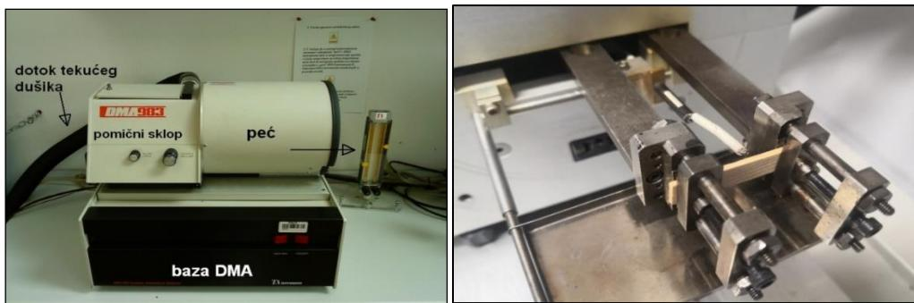
**Slika 25.** DMA analizator , DMA 983 TA Instruments,USA
