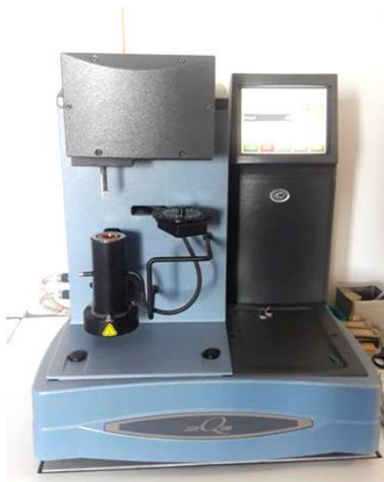
Slika 24. Termogravimetar Q500 tvrtke TA Instruments
