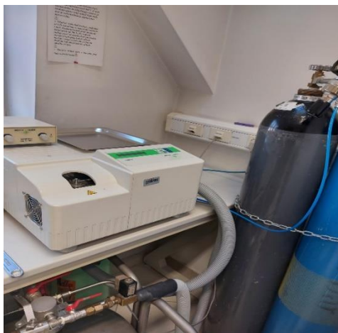
Slika 23. DSC uređaj MettlerToledo DSC 822e
