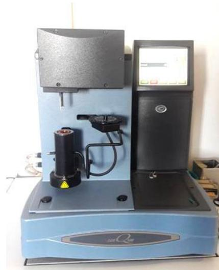
*Slika 24.* Termogravimetar Q500 tvrtke TA Instruments
