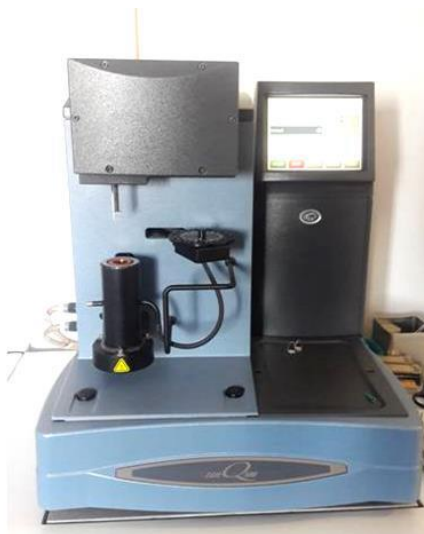
Slika 24. Termogravimetar Q500 tvrtke TA Instruments
