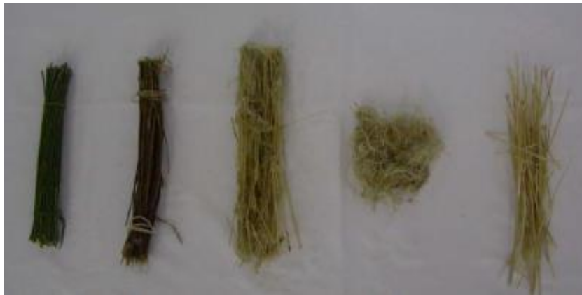
Slika 9. Različiti stadiji sušenja i pripreme za odvajanje vlakana brnistre [18]
