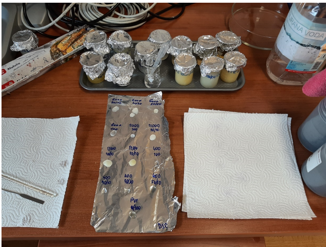
Slika 15. Pripravljene otopine PEG/PVP mješavina i priprava uzoraka za DSC i TGA analizu.
