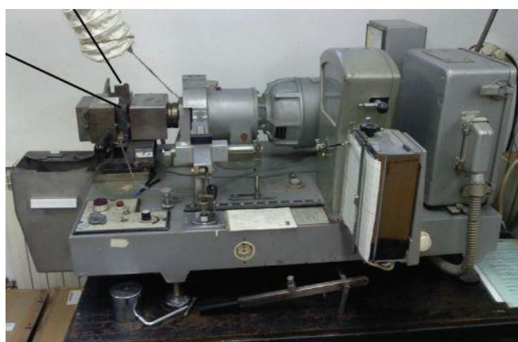
Slika 16. Brabender gnjetilica za umješavanje uzoraka
