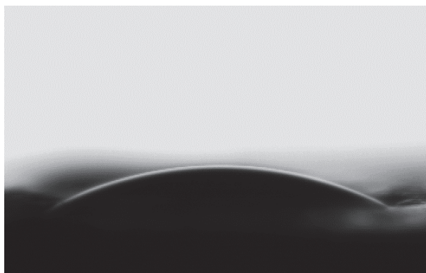
Slika 27. Kapljica vode na površini TPS filma oznake G-L5 HDMS
