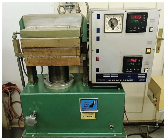
Slika 15. Hidraulička preša *Fontune Holland*
