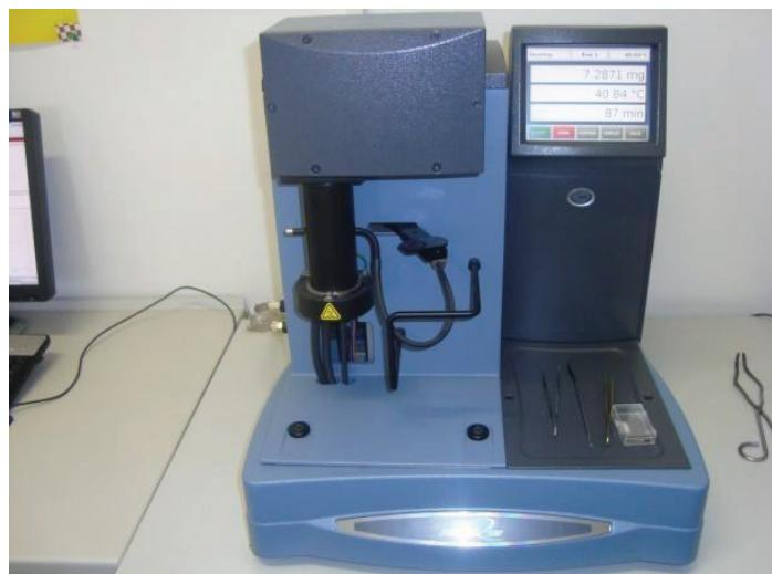
**Slika 19.** Termogravimetar TA Instruments Q500
