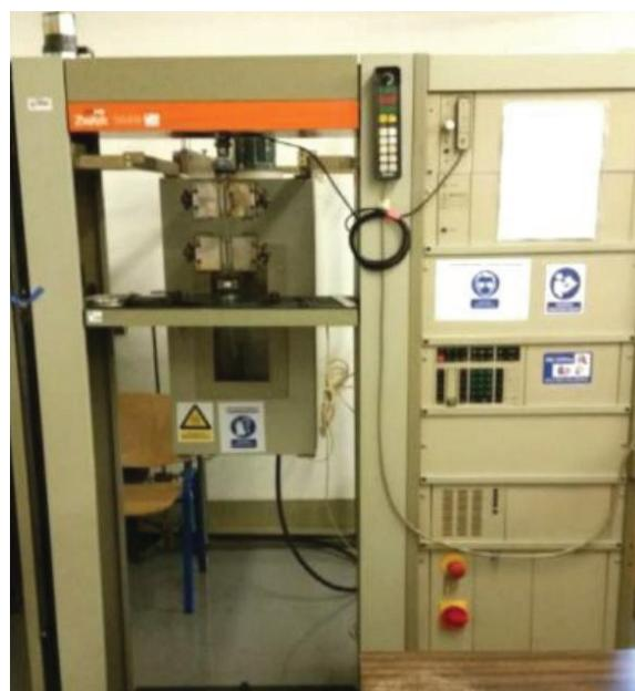
Slika 21. Zwick 1445 kidalica za mehanička ispitivanja
