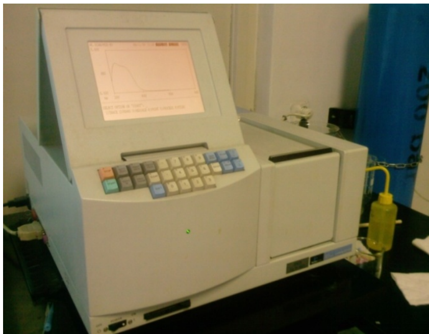
Slika 7. UV/VIS spektrofotometar, Lambda EZ 201, Perkin Elmer
