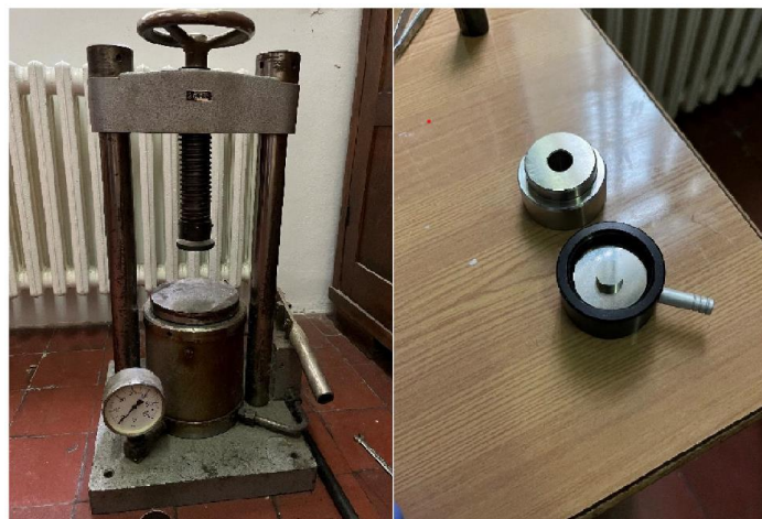
Slika 29. Preša i kalup za tabletiranje.
