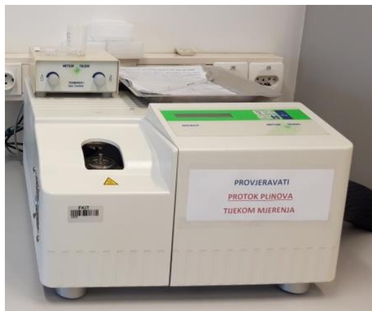
Slika 32. Diferencijalni pretražni kalorimetar Mettler Toledo DSC 823e.
