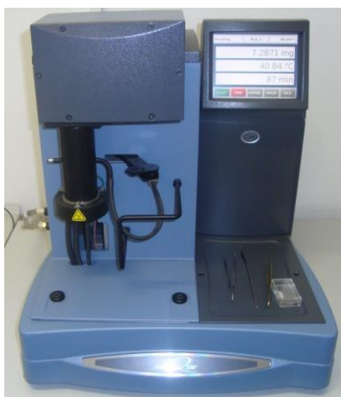
Slika 33. Termogravimetar TA Instruments Q500.
