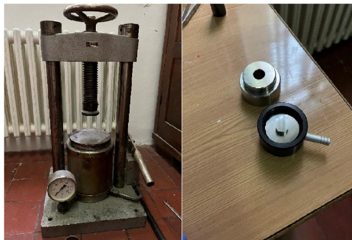
Slika 29. Preša i kalup za tabletiranje.
