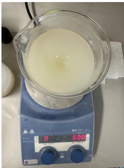
Slika 25. Postupak pripreme uzoraka, miješanje na magnetskoj miješalici.
