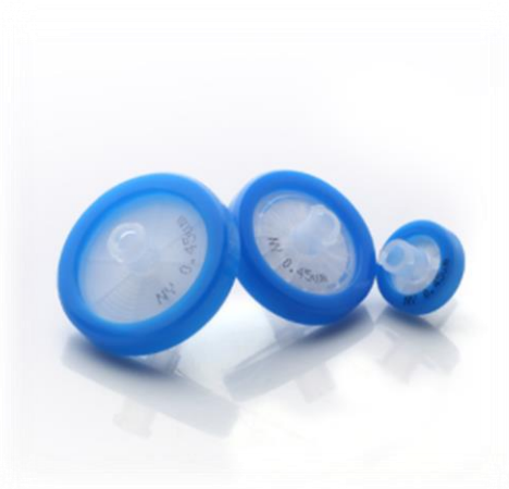
Slika 12. Šprica i filteri korišteni za filtriranje uzoraka [47,48]
