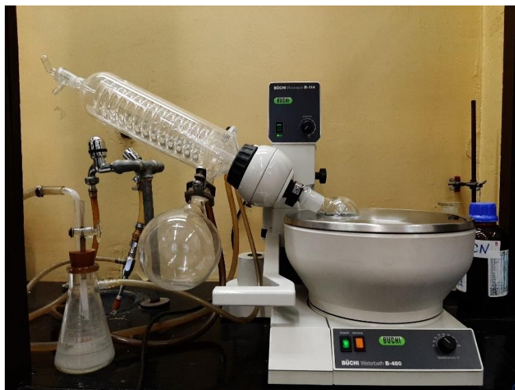
Slika 23. Rotavapor, Büchi Rotavapor R–114
