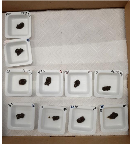
Slika 28. Odvage uzoraka aktivnog mulja
