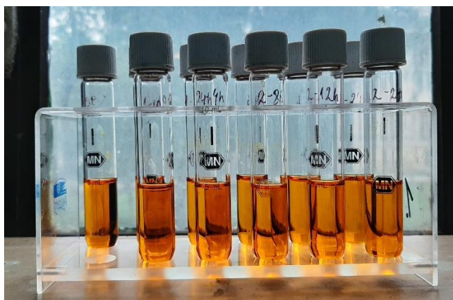
Slika 34. Staklene kivete s uzorcima za određivanje KPK
