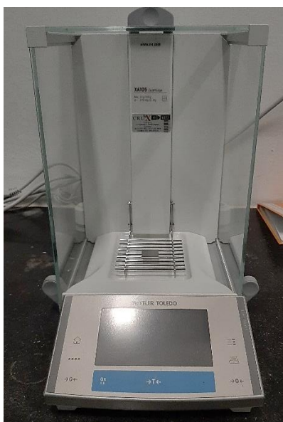
Slika 9. Analitička vaga XA105 DualRange, Švicarska
