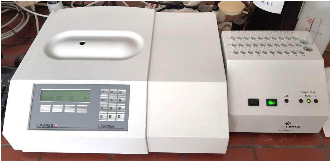
Slika 20. Instrument LUMISTox 300 s inkubacijskim blokom LUMISTherm, Njemačka
