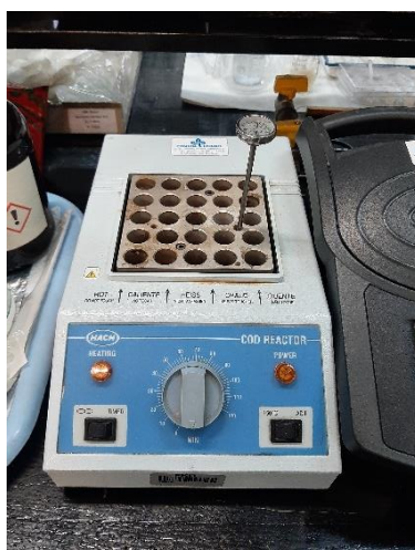
Slika 16. Termostatski blok, HACH, SAD
