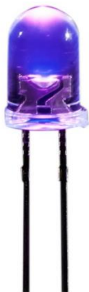
Slika 7. LED dioda koja emitira UV zračenje [36]
