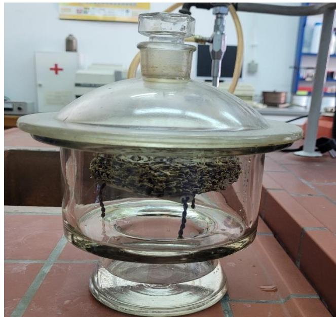
**Slika 3.7.** Proces otpuštanja mehaničke vode - kompozit u eksikatoru
