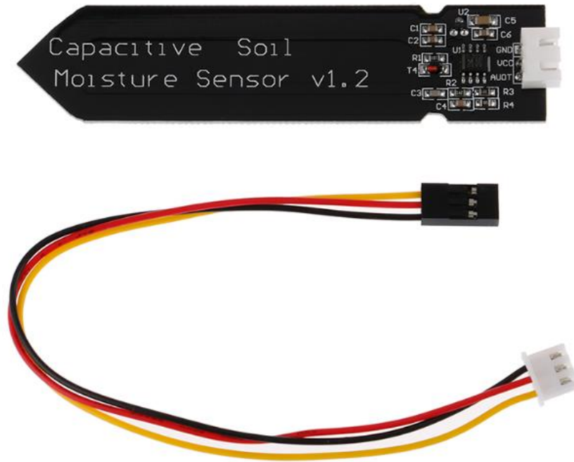
Slika 2.8. Kapacitivni senzor vlage
