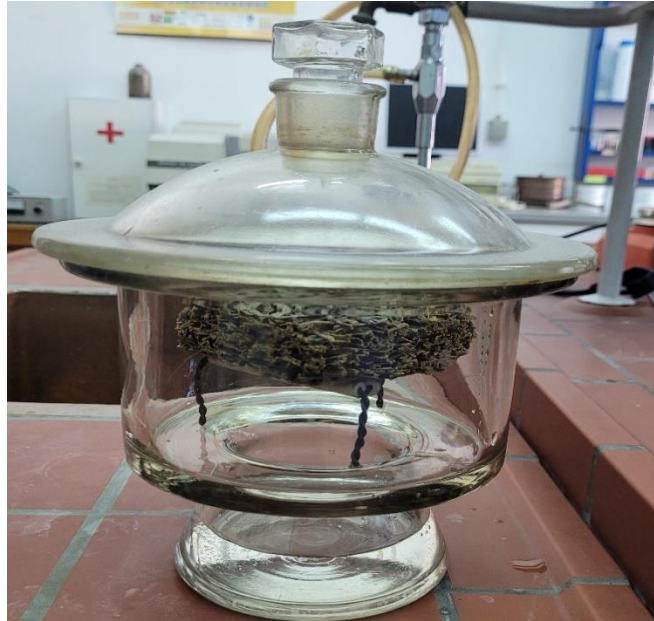
Slika 3.7. Proces otpuštanja mehaničke vode - kompozit u eksikatoru
