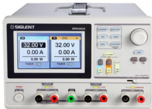
Slika 3.5. Laboratorijski izvor napona, SIGLENT SPD3303s
