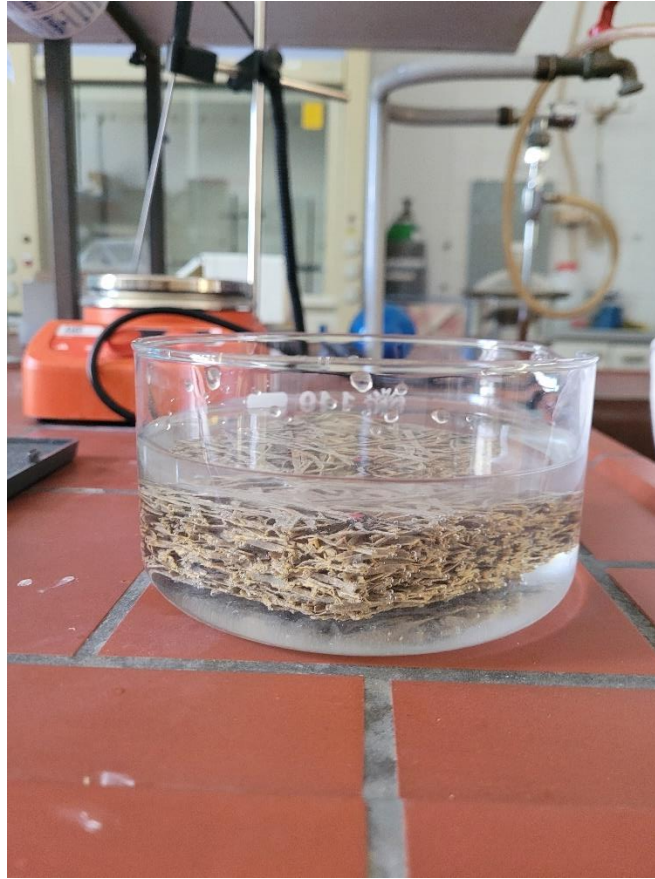
Slika 3.6. Vlaženja drvocemetnog kompozita - potopljen u vodi
