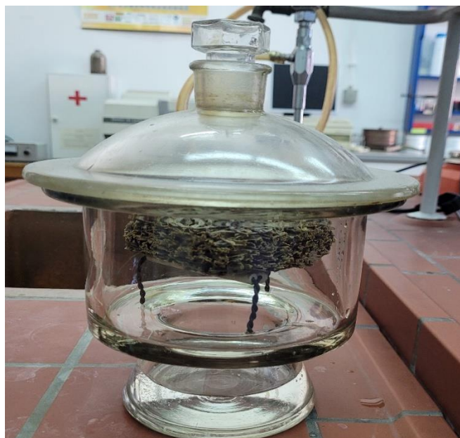
Slika 3.7. Proces otpuštanja mehaničke vode - kompozit u eksikatoru
