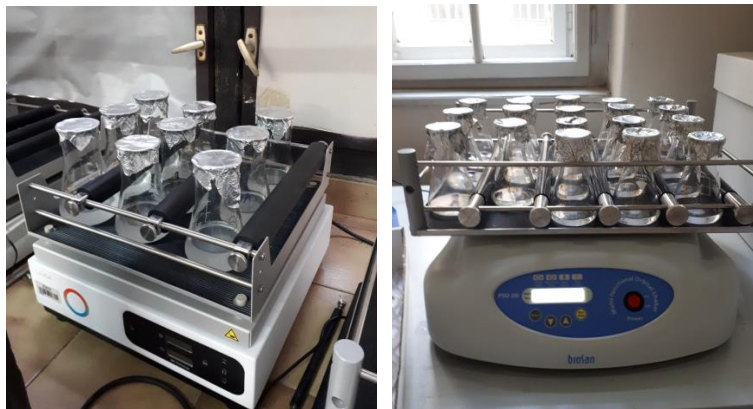
Slika 3.9. Postavljene tikvice za provedbu pokusa biorazgradnje PS-a.
