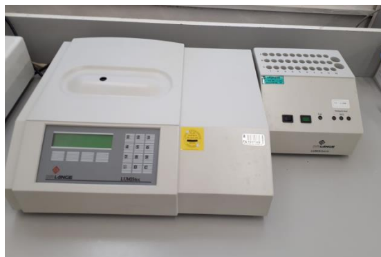
Slika 3.7. Luminometar LUMIStox 300 i termometar LUMIStherm, Hach-Lange GmbH.
