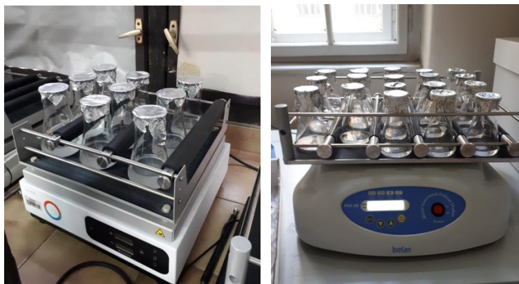
Slika 3.9. Postavljene tikvice za provedbu pokusa biorazgradnje PS-a.
