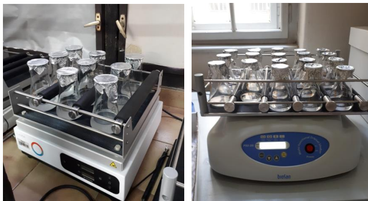
Slika 3.9. Postavljene tikvice za provedbu pokusa biorazgradnje PS-a.
