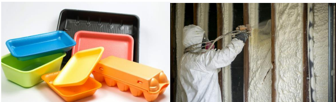
Slika 2.4. Primjer upotrebe PS-a u obliku ambalaže i toplinske izolacije [32]
