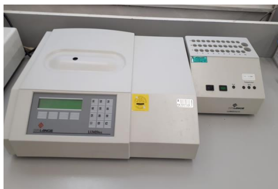
Slika 3.7. Luminometar LUMIStox 300 i termometar LUMIStherm, Hach-Lange GmbH.
