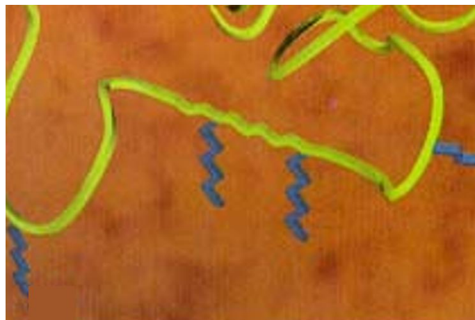
Slika 2.5. Polimerni aditiv s dugim bočnim alkilnim lancima (plavo); osnovni lanac polimernog aditiva (žuto) 4
