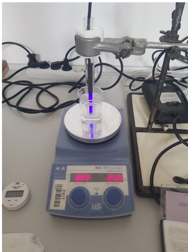
Slika 4. Eksperimentalni sustav sa Pen-Ray lampom
