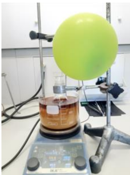
Slika 17. Reakcija dobivanja PEDOT-g-PAU:S-SEBS kompozita
