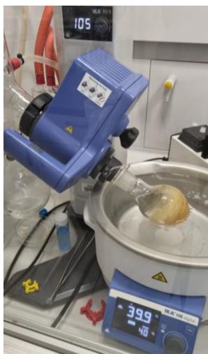
Slika 15. Otparivanje otapala na rotacijskom otparivaču
