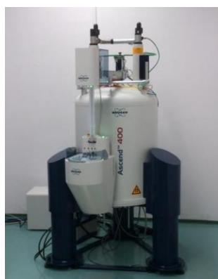
**Slika 20.** Bruker Avance III HD spektrometar
