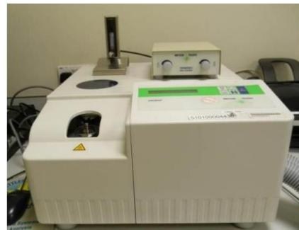
**Slika 23.** Mettler Toledo DSC 823eT kalorimetar
