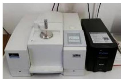
**Slika 21.** Perkin Elmer Spectrum One spektrometar
