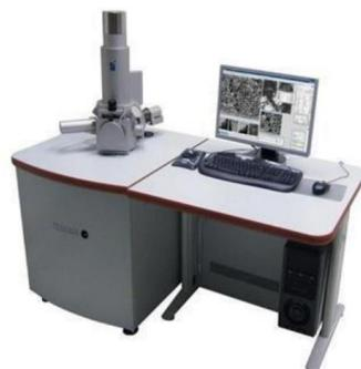
**Slika 25.** Pretražni elektronski mikroskop Tescan Vega 3
