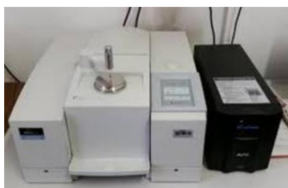
Slika 21. Perkin Elmer Spectrum One spektrometar
